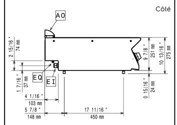
EI = Connexion électrique EQ = Vis équipotentiel
